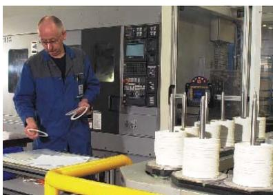
Nouvelle ligne de production de joints d'étanchéité en PTFE pour le marché automobile dans l'usine 3P de Langres (France).
