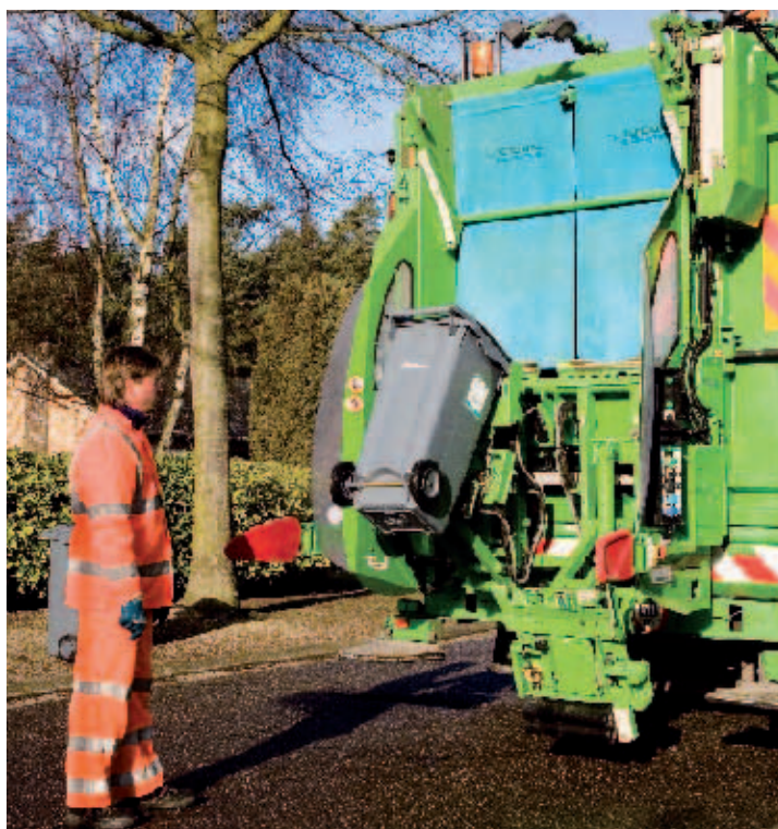
Collecte de bacs équipés d'un système d'identification électronique (syndicat intercommunal IOK, Belgique)
