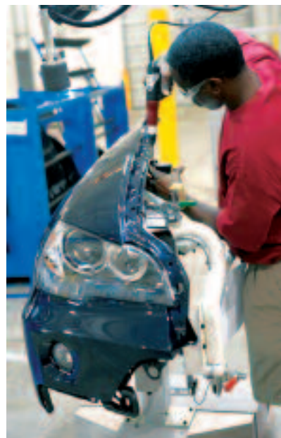
Assemblage du module d'aile du BMW X5 à Duncan (Caroline du Sud, USA)
