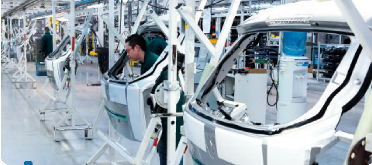
Ligne d'assemblage du hayon de la Renault Laguna break à l'usine IPO-RCS de Sandouville (France)
