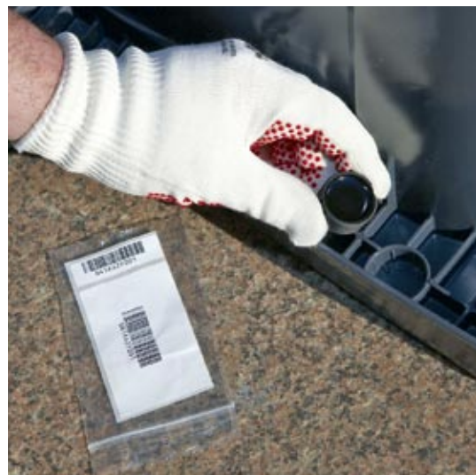
Pose d'une puce électronique qui permet l'identification du bac, la gestion des données de collecte et la facturation incitative au tri des déchets
