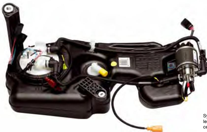
Système SCR « DINOx » d'INERGY, conçu pour réduire les émissions de NOx des moteurs diesel. Audi a retenu ce système pour ses modèles Q7 et A4.
