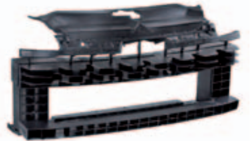
Dispositif de gestion du choc piéton pour la protection de la jambe.
